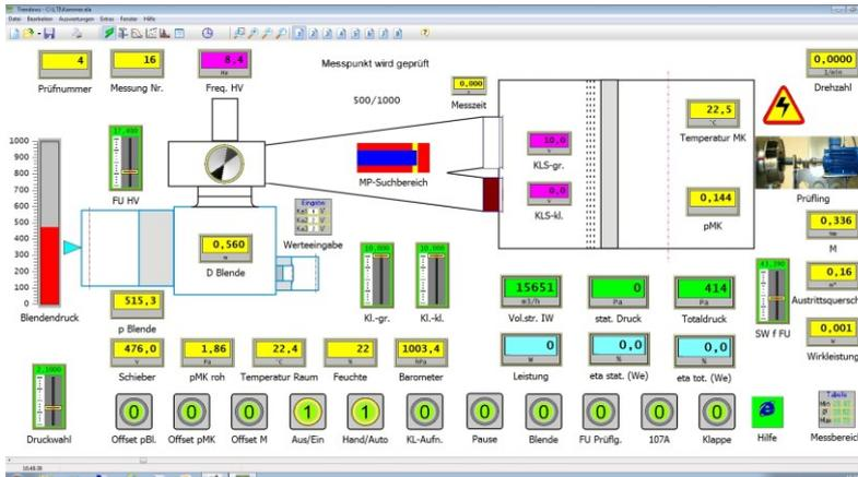
Visualisierung eines Ventilatorprüfstandes mit Bild-elementen für die Anzeige der Messwerte und Bedienung.
