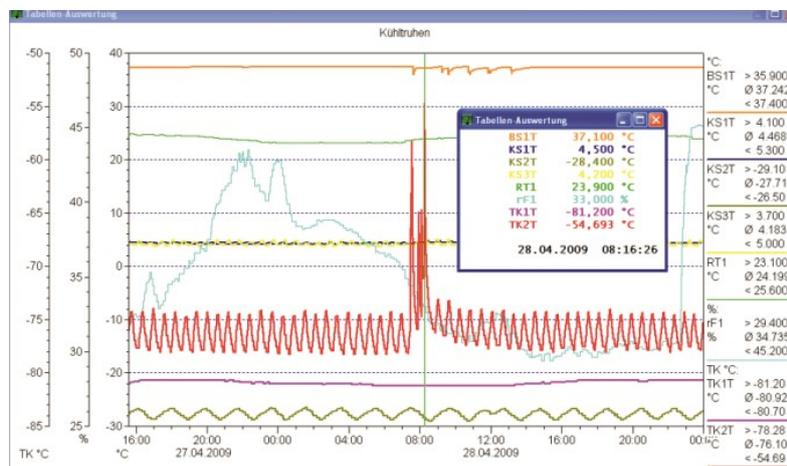
In dem Bild einer Auswertung erkennt man, dass die Peaks eindeutig durch die dyn. Abspeicherung erfasst werden.
